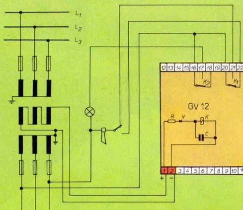
Stejnoseměrné relé GV 22 je napájeno ze středu rezistorového děliče (vestavěn do krytu), připojeného oběma konci přímo na napětí sítě. Při zemním svodu je rovnováha děliče porušena, napětí na rezistoru vzroste nad rozběhovou hodnotu relé. Relé působí již při zemním svodu s odporem  $R_z = \frac{E^2}{10}$  (V,  $\Omega$ ), kde E je napětí kontrolované sítě.
